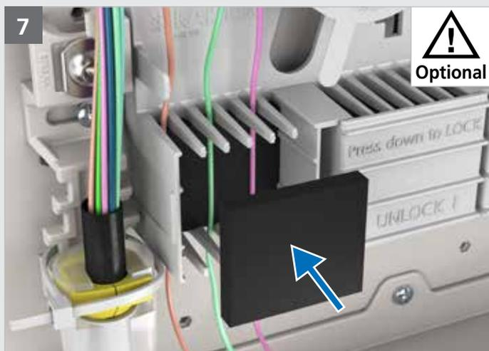
**Optional:** Je nach Anzahl der Bündeladern die einzelnen Ebenen der Zugentlastung belegen und mit den Dichtungen versehen.
