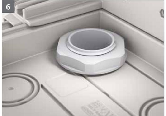
6 Gegenmutter auf Kabelverschraubung schrauben und festziehen (Zulässiges Drehmoment: 6 Nm).
