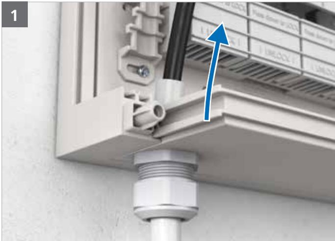
1 Hauptkabel und Mikrorohr (7/10/12/14/16 mm) durch die Kabelverschraubung einführen und Verschraubung anziehen.
