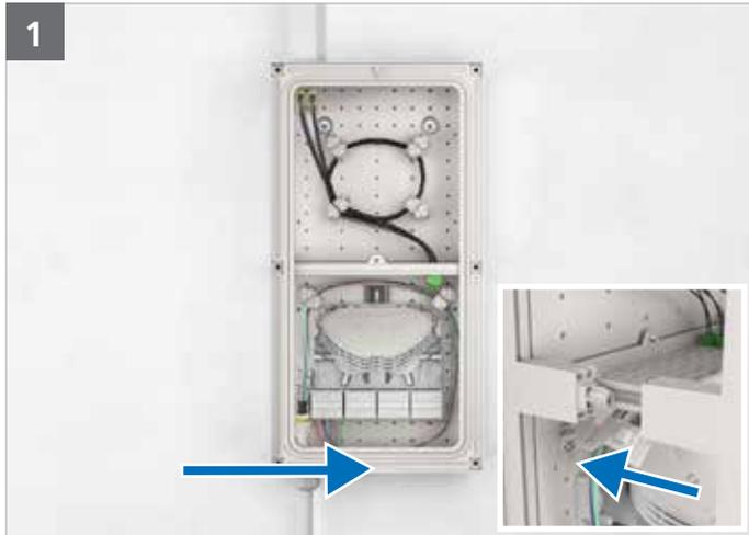
Dome des Gehäuse Oberteils auf die Dome des Gehäuse Unterteils setzen und verschrauben. Darauf achten, dass der Spalt im Rahmen unten ist.
