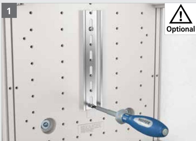
**Optional:** Hutschiene im Gehäuse Unterteil einsetzen und mittels mitgelieferter TX20 Schrauben auf den Anschraubpunkten fixieren.
