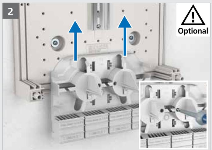
**Optional:** Mischer von unten auf die Hutschiene aufschieben und mittels mitgelieferter TX15 Schrauben am unteren Ende der Hutschiene fixieren.
