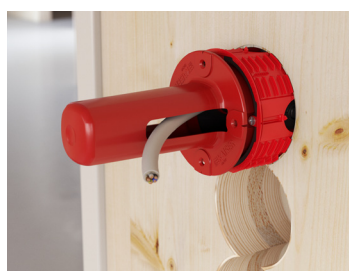
Il suffit d'enfoncer la boîte dans l'orifice d'encastrement de Ø 74 mm de la paroi en bois massif à l'aide de l'outil de pose (n° art. 1090-12).
