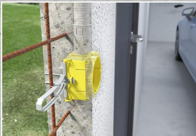
Le **système Flat 45** a été spécialement conçu pour la fabrication de garages préfabriqués en béton. Les boîtes d'installation électrique, la plupart du temps intégrées dans la cage d'armature, peuvent être positionnées sur l'armature à l'aide des **éléments de fixation et d'appui Flat 45** et fixées de manière sûre à l'aide de fil de fer tubulaire.
