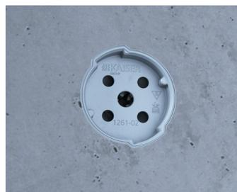
Des lèvres d'étanchéité sur tout le pourtour protègent l'aimant de retenue du système contre l'influence du béton sur la face avant, tandis que les écarteurs extérieurs permettent d'entourer complètement le logement de l'aimant.
