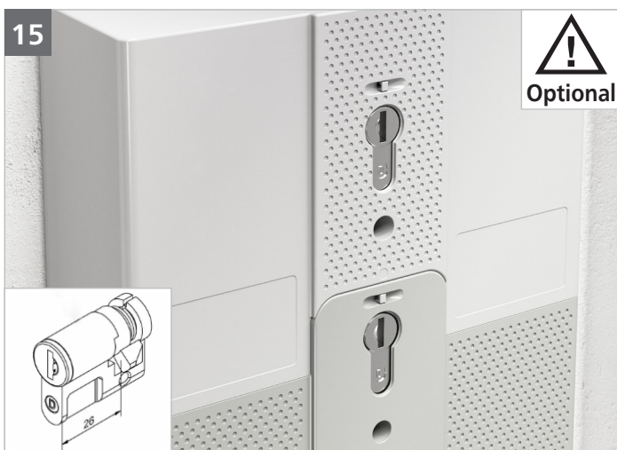
15 Optional: Schlösser vor Montage einsetzen (Zubehör). Eingesetzt werden kann ein Schloß nach DIN 18252, Profil- halbzylinder 30/10 (Außen/Innen), Daumen selbststeinrastend / federnd. Staubschutz, Schließdaumen 45°.
