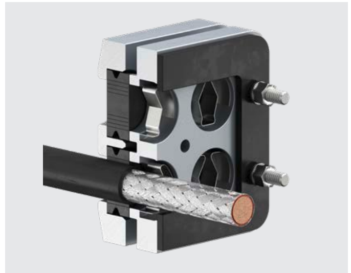
Querschnitt MCE EMV mit abgemanteltem Kabel
