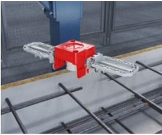
Mit dem Prefix®Universal-Auflager lassen sich alle End-und Über- gangstülsen sowie die Wand- und Deckenkrümmen 30° für die Werksfertigung...
