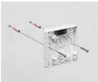
5 mm Bohrlöcher erstellen.
