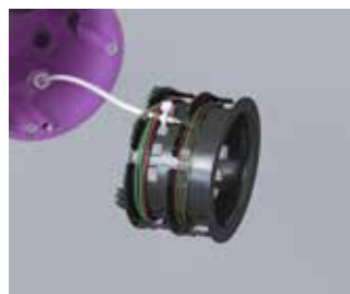
Pigtails auf der Fasermanagement Trommel ablegen.
