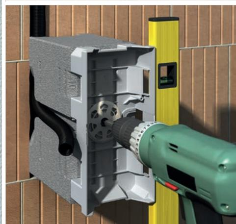
**Конзолата за гъвкави системни решения с междинни монтажни плочи** е подходяща за монтаж в топлоизолация с дебелина от 160 до 310 mm. Модулната система позволява сглобяването на „стъпки“ от 10 mm, което осигурява възможност за гъвкаво адаптиране към изолационната система.
