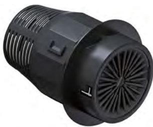
Auf der Innenseite des Schottzylinders angeordnete Lamellen sorgen für ein schnelles Verschließen im Brandfall.
