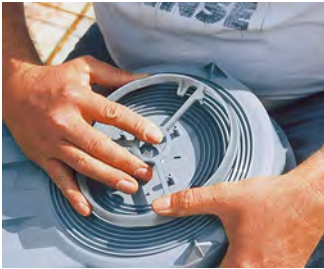
Frontring am Gehäuse einrasten.
