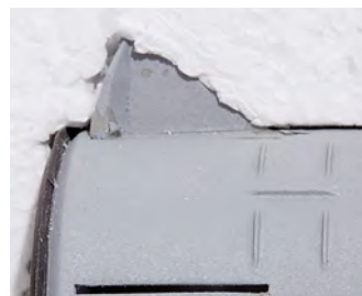
Die Schwenkschneiden verankern die Dose stabil in der Dämmung. Die Klemmrippen im vorderen Bereich fixieren die Dose zusätzlich.
