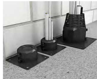
Mischbelegung von Leitungen und Rohren bis zur Vollbelegung. Auch eine Gruppenanordnung mit einem Abstand von 205 mm (DS 90 / 120 mm) oder 125 mm (DS 90 / 74 mm) ist möglich.
