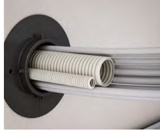
Vollbelegung mit Mantelleitungen bis \varnothing 29 mm und Rohren bis M63.
