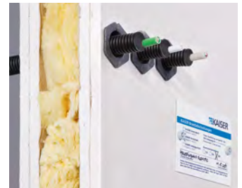
Die Rohrschotts können in einem Mittenabstand von 50 mm als Gruppe waagrecht oder senkrecht angeordnet werden.
