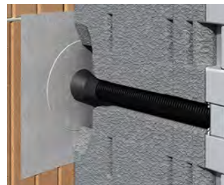
Für die luftdichte Installation die Rohr-Austrittsstelle mit einer geeigneten Luftdichtungsmanschette...
