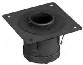
Teilbare Montagehülse mit Kantenschutz aus dämmschichtbildendem Material.
