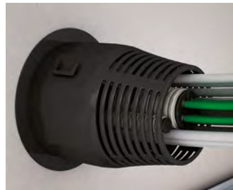
Zweiteiliges Dichtelement um das Bündel legen, verschließen und über den Bajonettverschluss mit dem Schottzylinder verbinden.
