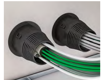
In einem Abstand von 50 mm ist eine waagerechte Anordnung der Schotts möglich.
