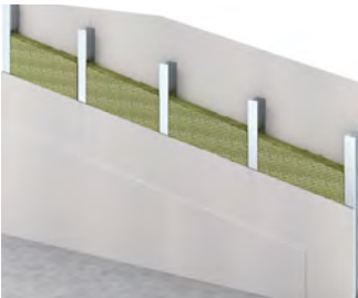
Aufbau einer F90 Metallständerwand nach DIN 4102 Teil 4
